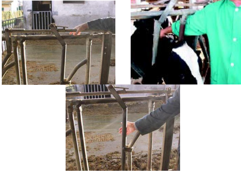
Figura 68: Esempi di elementi della recinzione (nei quali non inserire le mani).
